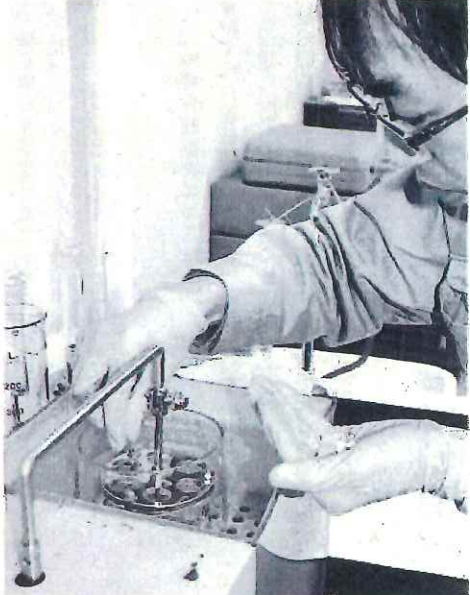
錠剤が体内で溶けて崩れるかを調べる試験＝名古屋市熱田区で
